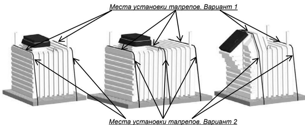
5.13. Уложить утеплитель по всей площади верха погреба и вокруг стенок на глубину промерзания, но не менее чем на 1 метр. Утеплитель закрепить с помощью монтажной пены или клейкой армированной ленты, как указано в *Приложениях*. Толщина слоя утеплителя должна составлять не менее 100 мм. Стыки и полости в утеплителе заполнить монтажной пеной. Трубы вентиляции, находящиеся в грунте, утепляются вспененным теплоизолятором для труб, толщиной не менее 10 мм.
